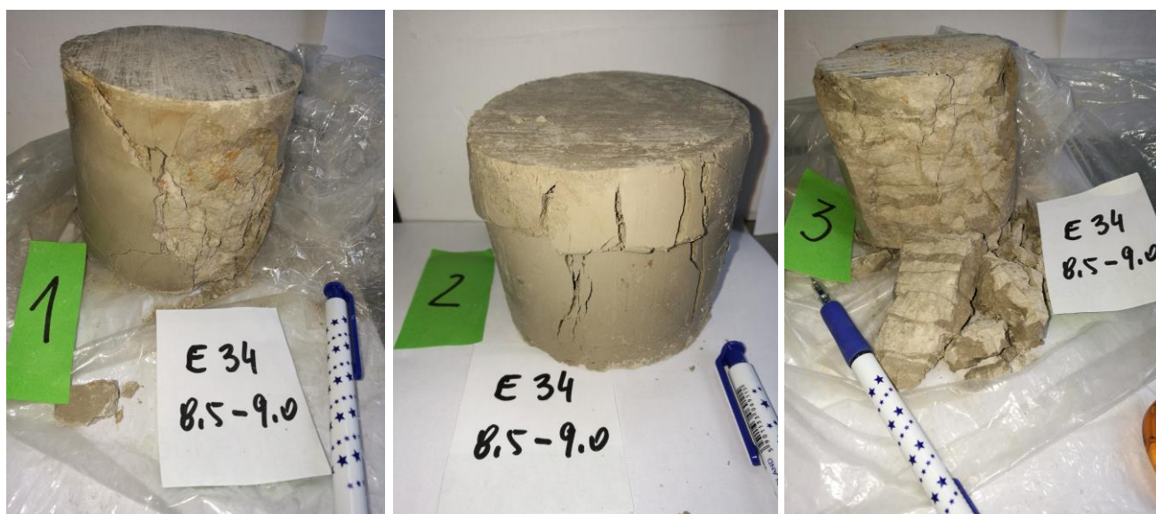
Fot. 1 – 2 – 3. Próbki skał przebadane pod względem wytrzymałości na ściskanie R_c . Wyk. Geotech Sp. z o.o.
